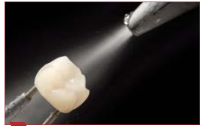
3 Temeljno očistite površinu (npr. paročištačem).
