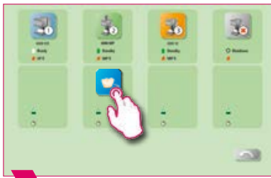
2 Forni multipli: tener premuto il programma di cottura e spostare, se si desidera un altro forno per l'esecuzione.
