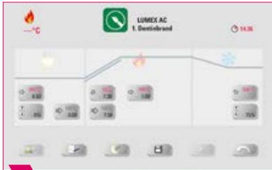
**4** Окно обжига с одноступенчатой кривой.
