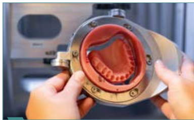
2 Mill the final denture base (hier: upper jaw).
