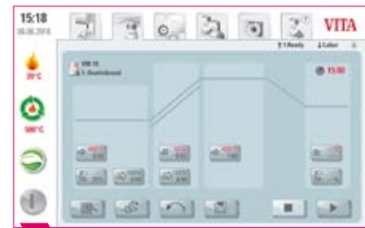
3 Fenêtre de cuisson avec courbe à un niveau.
