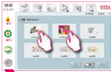
2 Appuyer longuement sur la première image jusqu'à ce qu'elle soit sélectionnée. Appuyer brièvement sur d'autres images pour les sélectionner.
