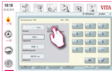
5 Phase de refroidissement 2 : sélectionner « Refroidissement contrôlé ».
