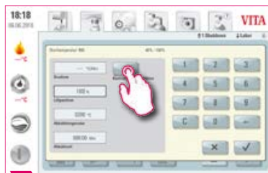
8 Phase de refroidissement 3 : sélectionner « Refroidissement contrôlé ».
