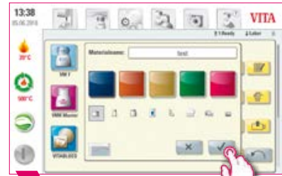
6 Type de courbe de cuisson, sélectionner une couleur d'arrière-plan et valider.
