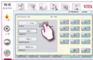
2 Phase de refroidissement 1 : sélectionner « Refroidissement contrôlé ».
