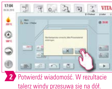
1 Start programu tłoczenia bez obiektu przeznaczanego do tłoczenia.
