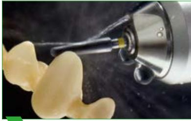
**1** Bearbeitung mit Turbine unter Wasserkühlung.
