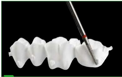
4 Verbinder mit Diamanten oder Hartmetallfräse verschleifen.
