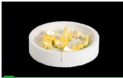
**1** Manuell voreingefärbte Restaurationen in der Sinterschale MS fertig zum Speedsintern.
