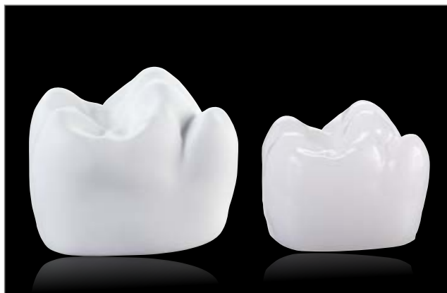
Abbildung 6: Beispiel für Sinterschwindung von Zirkondioxid um ca. 20 %
