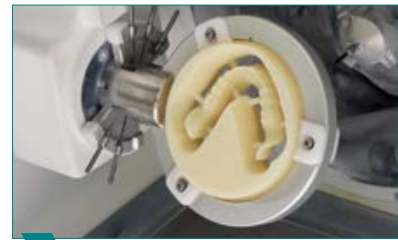
3 Die Wachs-Disc für die vollformatige Wachseinprobe (UK) fräsen.
