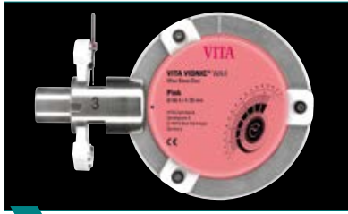
1 Die Wachs-Disc Pink in das Haltersystem einspannen.
