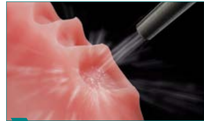
6 Die gefrästen Kavitäten der Prothesenbasen abstrahlen.
