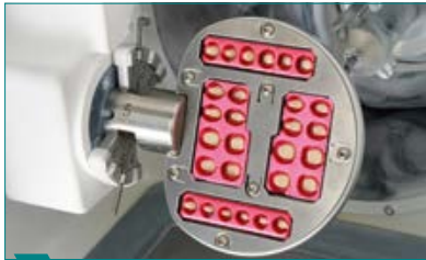
4 Die Prothesenzähne mittels CAM modifizieren (siehe 6.3).
