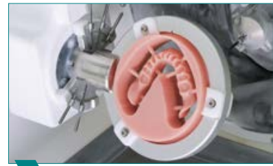
3 Die definitive UK-Prothesenbasis fräsen.
