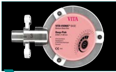
1 Die-PMMA Disc in das Haltersystem einspannen.
