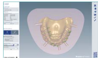
12 Nesting der Prothesenbasen (OK und UK).
