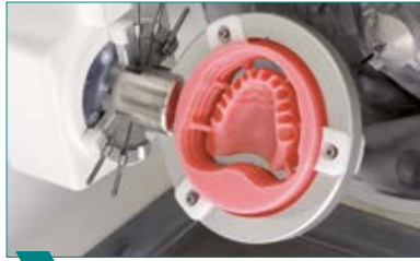
2 Die Wachs-Disc (OK und UK) fräsen für die Einprobe.
