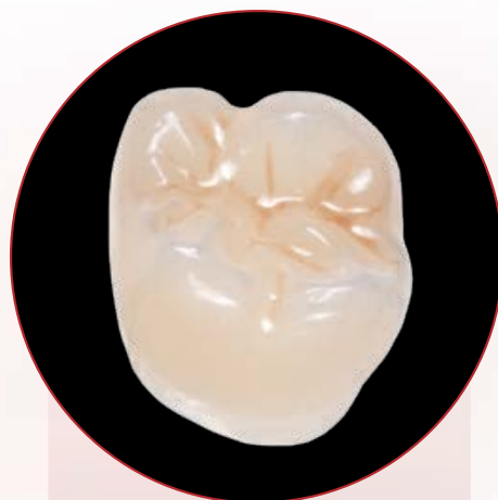
Pomalowana korona przed testem na zużycie
