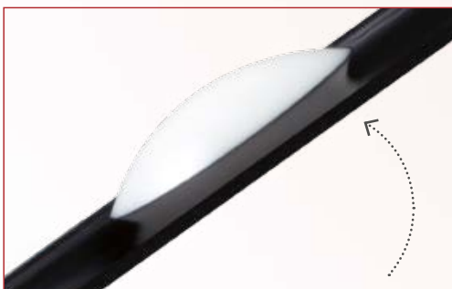
2. Test stabilności materiału poprzez pochylenie płytki
