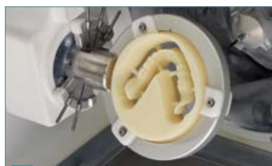
4 Fraisage du disque de cire pour la prothèse en cire pour l'essayage (mandibule).
