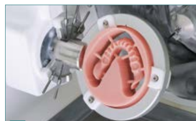
3 Fraiser la base prothétique mandibulaire définitive.
