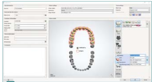
2 Appliquer Gingiva : Type : « Base avec dent de confection » ; Matériau : « VITA VIONIC BASE HI ». Processus de fabrication : « Fraisage VITA VIONIC BASE ».
