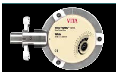
2 Insérer le disque de cire blanche dans le système de support.
