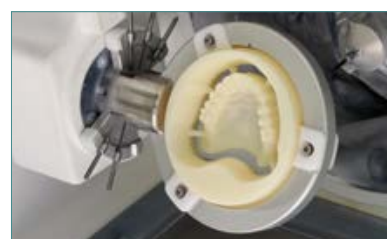
3 Fraisage du disque de cire pour la prothèse en cire pour l'essayage (maxillaire).
