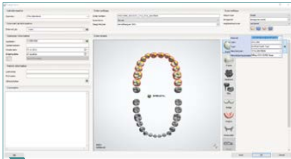
1 Créer un cas et marquer les dents à remplacer ; Type : « Type de dent artificielle » ; Matériau : « Dent artificielle VITA VIONIC VIGO ». Processus de fabrication : « Fraisage VITA VIONIC BASE »
