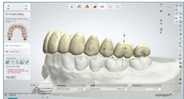
6 Adaptation de l'occlusion aux antagonistes par positionnement individuel des dents ; en option : morphing (modification individuelle) de la géométrie des dents.
