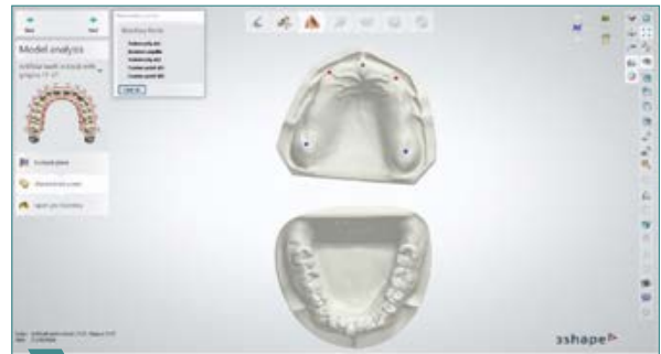
4 Scanner ou importer des données de scannage, définir le plan d'occlusion et effectuer l'analyse du modèle comme d'habitude.
