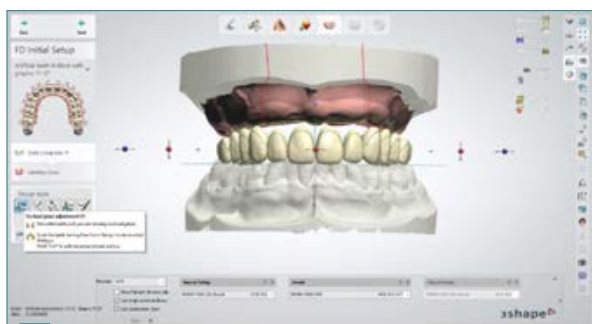
5 Scelta della biblioteca denti e posizionamento approssimativo dei denti.
