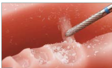
4 Staccare le basi protesiche dal disco. Levigare a filo le zone di impernatura.
