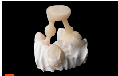
5 Feinausbetten und Reaktionsschicht entfernen mit Glasperlstrahlmittel bei 2 bar Druck.
