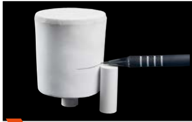
1 Mit zweitem Pressstempel die Einpresstiefe durch Markierung bestimmen.
