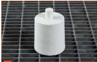
8 Nach Entnahme der Muffel, diese an geschütztem Ort abkühlen lassen.
