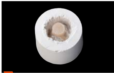
4 Grobausbettung mit \text{Al}_2\text{O}_3 (50 \mu\text{m} Körnung) bei 4 bar Druck durchführen.
