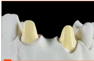
2 2. Schicht Distanzlack bei Front- und Seitenzahnbrücken.
