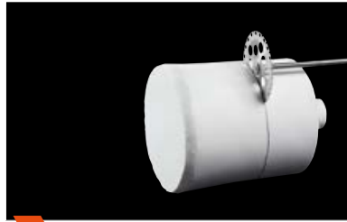
2 Einbettmasse entlang der Markierung zirkulär tief einschneiden.
