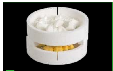
9 Sinterización simultánea de restauraciones Color/Multicolor precoloreadas y restauraciones coloreadas manualmente.
