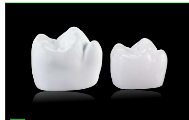
3 Molaire avant et après le frittage ; diminution au frittage d'environ 20 pour cent.
