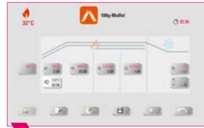
3 Pressionar brevemente o programa de queima para acessar o painel de queima.
