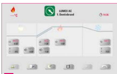
4 Painel de queima com curva de um nível.
