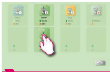
2 Multifornos: manter o programa de queima pressionado e mover, caso deseje-se executar a queima em um outro aparelho.
