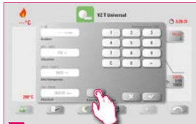
5 2a. fase de resfriamento: selecionar "Resfriamento controlado".
