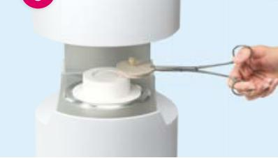
Prelevare il supporto di cottura col restauro e posizionarlo sul piano di raffreddamento.
