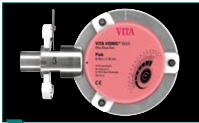
1 Insérer le disque de cire rose dans le système de support.
