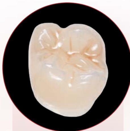
Corona maquillada, antes del ensayo de desgaste
