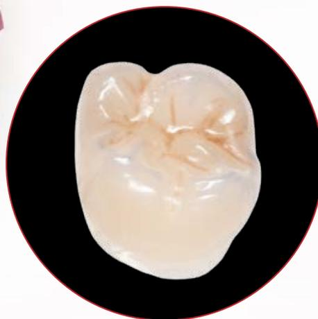
Corona maquillada, tras el ensayo de desgaste
