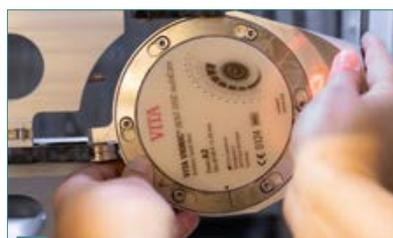
4 Fijar el VITA VIONIC DENT DISC multiColor en el soporte de la fresadora. Fresar la arcada dentaria/los elementos dentales.
