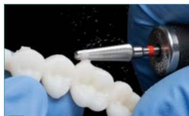
6 Desbastar los puntos de colocación de los jitos con la fresa de carburo de tungsteno de dentado cruzado.
