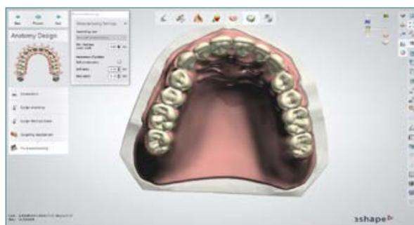
10 Modelar la encía; ajustar la corrección del radio de la fresa en función del diámetro del instrumento más pequeño utilizado y de la anchura de la cavidad (junta de adhesión recomendada: 80 µm o 0,08 mm).
