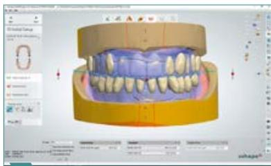
**12** Modificar mediante el Smile Composer la posición estética y funcional de los dientes. Utilizar el escaneo del rodete de cera para la alineación.
