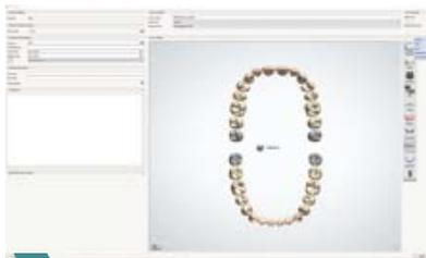
**1** Crear el caso y marcar los dientes que se deben sustituir; Type: Artificial Tooth Type; Material: VITA VIONIC VIGO Artificial Teeth; Manufacturing Process: Milling VITA VIONIC BASE.
