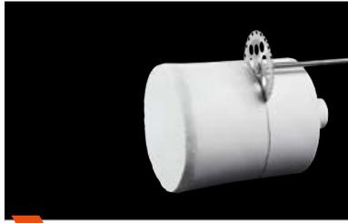
**2** Realizar un corte circular profundo a lo largo de la marca del material de revestimiento.
