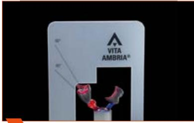
**1** Antes de la puesta en revestimiento, comprobar el peso de la cera y la colocación de los jitos.
