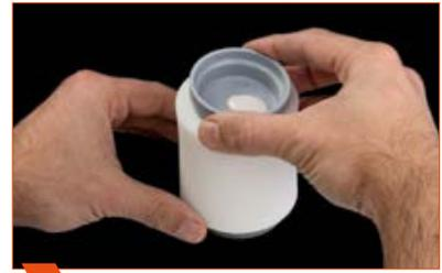
**3** Rellenar con material de revestimiento hasta el borde.
