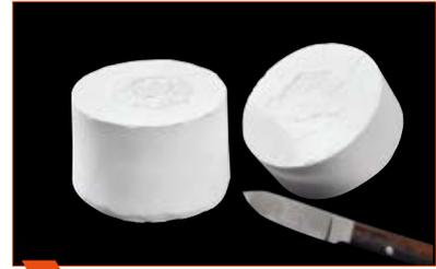
**3** Partir la mufla cuidadosamente por el punto de rotura utilizando un cuchillo.
