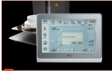
**2** Al abrir el horno aparecerá el mensaje "Introducir el material de prensado".
