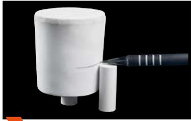
**1** Utilizar un segundo émbolo de prensado, marcando la profundidad de prensado.
