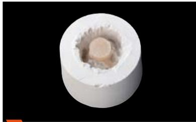
**4** Realizar la retirada basta del revestimiento con  $\text{Al}_2\text{O}_3$  (granulación de  $50\ \mu\text{m}$ ) a una presión de 4 bar.
