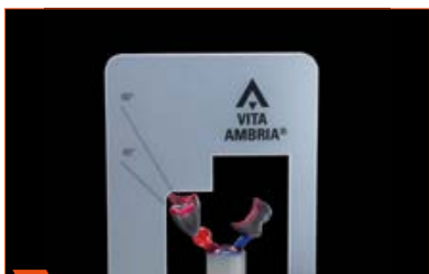
1 Beágyazás előtt viasz súly és csapozás ellenőrzése.
