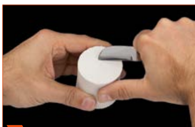
2 Az öntvény széleinek letörése, közben ne kerüljön beágyazómassza a csatornába.
