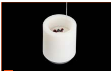
2 Beágyazómassza betöltése vékony sugárban a fogpótlásokig.
