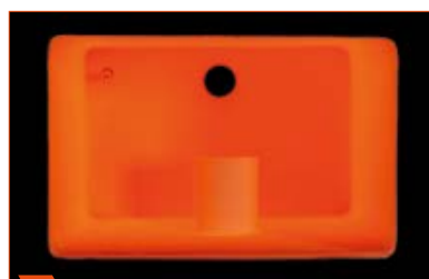
3 Öntvény elhelyezése a kályhában, nyílással lefelé. Ne érintkezzen a kályha falával.
