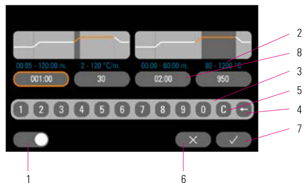
Figura 6 – Esempio di campo di modifica per vuoto
