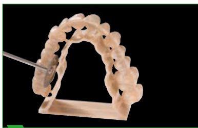
2 Hídkonstrukció óvatos leválasztása.
