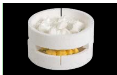
9 Előre színezett Color/Multicolor- és manuálisan színezett fogpótlások egyidejű szinterezése.
