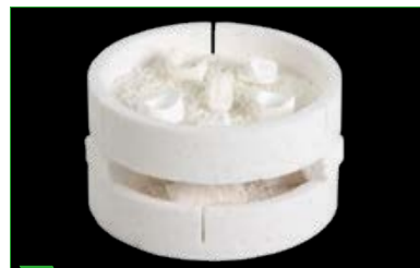
6 Color/Multicolor-fogpótlások szinterezése rakással.
