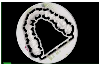
1 Hidak vázasított támasztó struktúrával a marás után.
