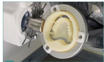
3 Die vollformatige Wachseinprobe (OK) fräsen.
