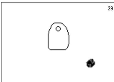
En primer lugar (círculo vacío), colocar la punta de medición en la zona cervical del diente y pulsar el botón de medición. Si el proceso de medición se ha realizado correctamente, suenan dos tonos seguidos y en la pantalla aparece un círculo relleno.
