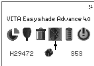
Para activar o desactivar el módulo Bluetooth integrado, marcar el icono de Bluetooth en el menú de configuración y pulsar el botón de selección. La representación del icono del módulo Bluetooth varía según el estado seleccionado. Con el módulo desconectado, el icono de Bluetooth estará tachado.
