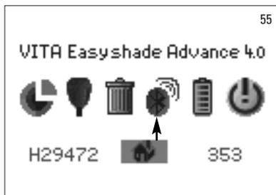
Para establecer una conexión con un ordenador debe activarse el módulo Bluetooth y enchufarse en un puerto USB del ordenador el módulo USB de Bluetooth incluido en el volumen de suministro. La primera vez que se enchufe el módulo en el PC, Windows (a partir de XP) instalará automáticamente los controladores del dispositivo. Para transferir los datos al ordenador se utiliza el software VITA Assist, incluido también en el volumen de suministro del VITA Easyshade Advance 4.0.
