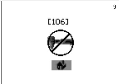
Si suena un único tono, aparece la pantalla que se puede ver en la figura de la izquierda (fig. 9) junto con un número de error (ver apartado 12.2). Significa que la calibración no se ha realizado correctamente y debe repetirse.
