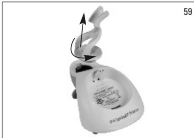
El VITA Easyshade Advance 4.0 solo debe calibrarse poniéndole una lámina protectora contra infecciones nueva. Si se contamina el bloque de calibración, debe retirarse de la estación de base junto con el soporte y esterilizarse en un autoclave de vapor siguiendo las indicaciones del fabricante del aparato de esterilización.
