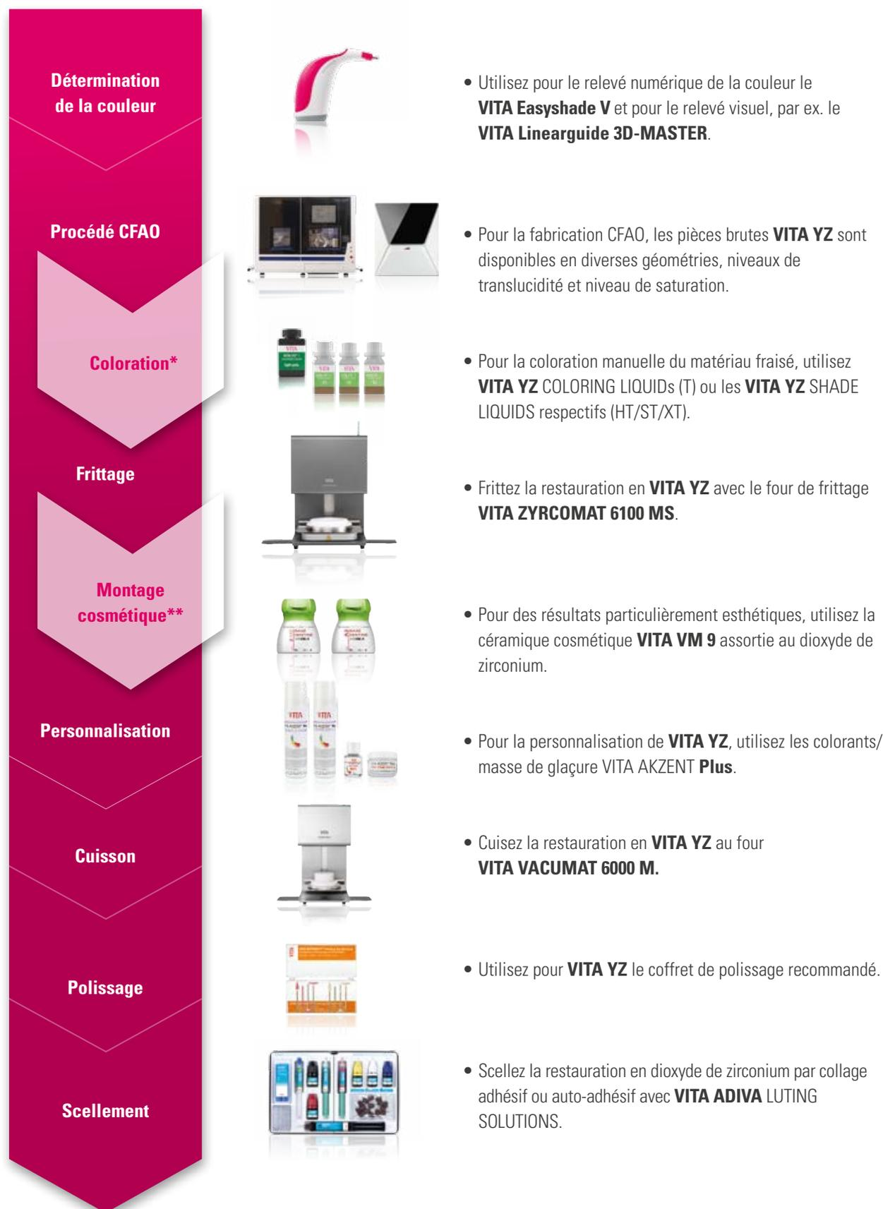
\*) Facultatif : la coloration avec VITA YZ COLORING LIQUIDS ou VITA YZ SHADE LIQUIDS est une étape de processus facultative. Il n'y a pas de coloration pour les pièces brutes préteintées YZ.
