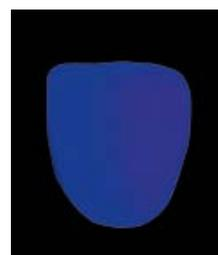
Fig. 9: Fotografia della fluorescenza di VITA YZ HT
