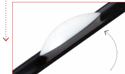
2. Comprobación de la estabilidad mediante la inclinación de la placa
