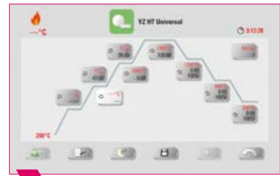
3 Appuyer brièvement sur le programme de cuisson pour accéder à la fenêtre de cuisson.
