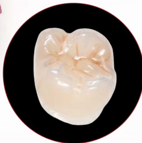
Namalová korunka po testu opotřebení
