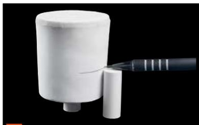
**1** Con un secondo pistone di pressatura stabilire la profondità di pressatura e segnlarla.
