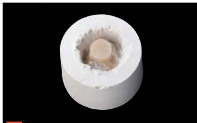
**4** Eseguire la smuffolatura grossolana con  $Al_2O_3$  (granulometria  $50 \mu m$ ) ed una pressione di 4 bar.
