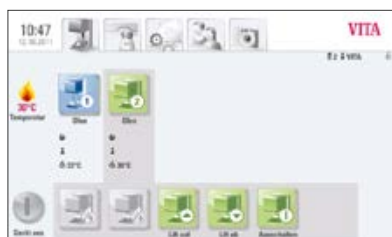
Картина 2: Стартова ситуация при включени 2 пещи уреда VITA New Generation
