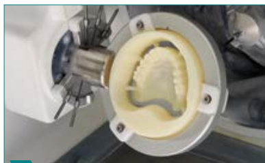
2 Фрезерование полноформатного примерочного образца (верхняя челюсть) из воскового диска.
