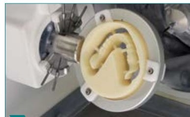
3 Фрезерование полноформатного примерочного образца (нижняя челюсть) из воскового диска.
