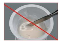
Las estrías y las burbujas se evitan respetando la proporción de mezclado y removiendo uniformemente la mezcla por el fondo del recipiente con la ayuda de un instrumento.
