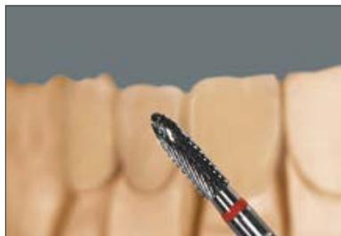
Per la finitura e le correzioni della forma usare frese in metallo duro con una velocità di 15.000 giri/min
