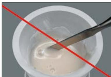
Bolle e striature si evitano osservando il corretto rapporto di dosaggio ed impastando uniformemente con lo strumento inserito fin sul fondo della scodella di miscelazione.
