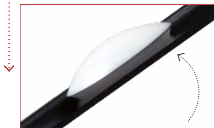
2. Contrôle de la stabilité par inclinaison de la plaque
