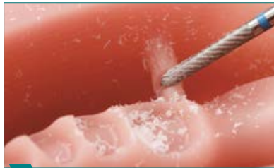
4 Die Prothesenbasen aus der Disc heraustrennen.
