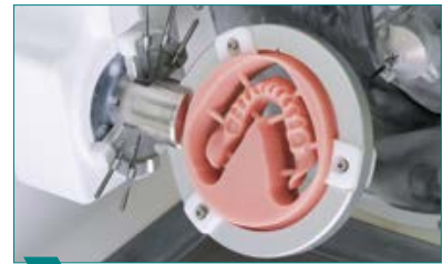
3 Die definitive UK-Prothesenbasis fräsen.
