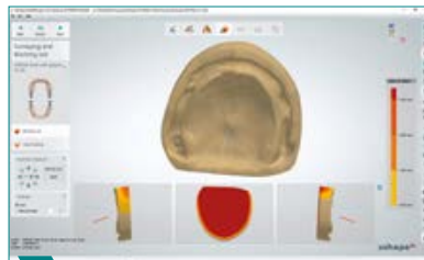
5 Die Einschubrichtung definieren. Hinterschnitte beachten.
