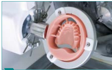
2 Die definitive OK-Prothesenbasis fräsen.
