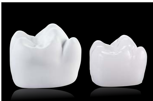
Illustration 6 : exemple de retrait au frittage du dioxyde de zirconium d'env. 20 %
