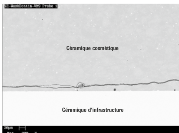
Illustrations 25 : VITA YZ T incrusté de VITA VM 9, trajet des fêlures dans le cosmétique, grossissement x 300
