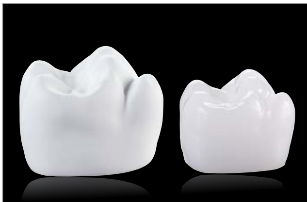
Εικόνα 6: Παράδειγμα συρρίκνωσης πυροσυσσωμάτωσης του διοξειδίου του ζιρκονίου σε ποσοστό περίπου 20%
