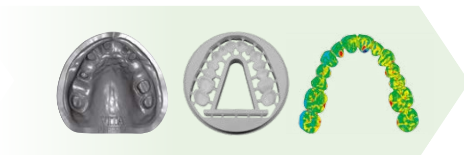
Figura 14a/b/c: a) Modelo; b) construção VITA YZ fresada, de múltiplos elementos; c) Software Wrap com estruturas sobrepostas (da esquerda para a direita)
