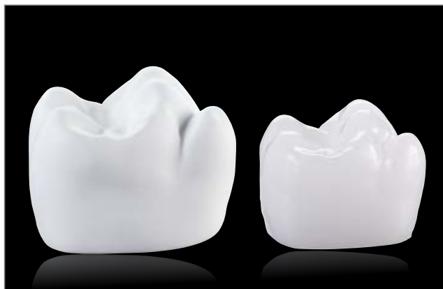
Figura 6: Exemplo de encolhimento de sinterização de cerca de 20% do dióxido de zircônio
