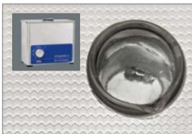
Titanbasis mittels Ultraschallwasserbad mit Alkohol oder durch Dampfstrahlen reinigen und mit ölfreier Luft trockenblasen.
