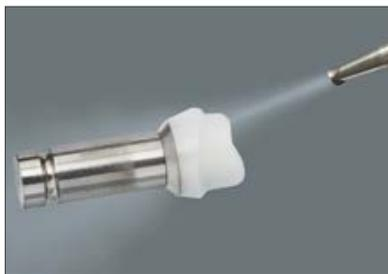
Anschließend mittels Ultraschallwasserbad, Alkohol oder durch Dampfstrahlen reinigen und mit ölfreier Luft trockenblasen.
