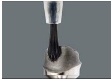
Nach der Reinigung darf die zu verklebende Oberfläche nicht mehr berührt werden, da dies zu einer Kontamination führen kann, die den anschließenden Klebeverbund negativ beeinflussen kann.
