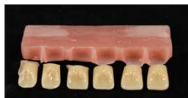
Figura 15 b: Patrón de rotura; no se llevó a cabo un tratamiento previo de la superficie de la base del diente.
