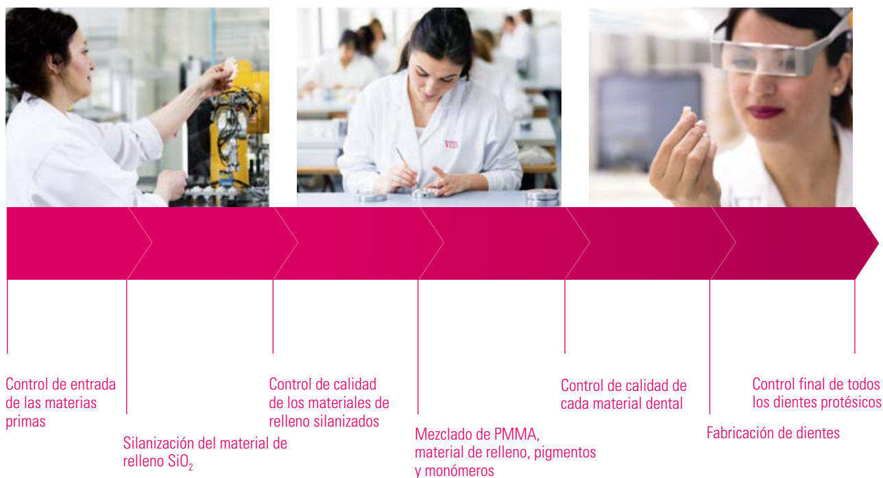
Figura 9: Proceso de fabricación de los dientes protésicos VITA; fuente: I+D de VITA.
