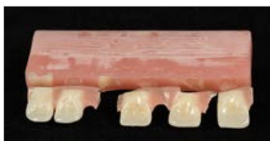
Figura 15 a: Patrón de rotura; se arenó la base del diente y se humedeció con agente adhesivo.
