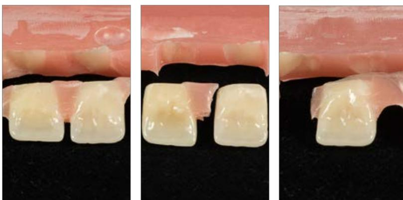
**Illustration 14 a – c :** schéma de rupture caractéristique au test de liaison de VITA PHYSIODENS avec les matériaux de base susmentionnés (matériaux de base de la gauche vers la droite : FuturaGen, ProBase Cold, PalaXpress)
