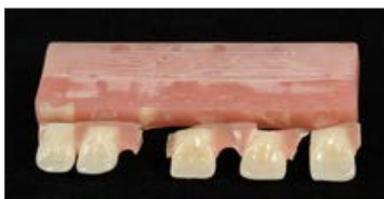
Illustration 15 a : schéma de rupture ; la base de la dent a été sablée et un adhésif a été appliqué
