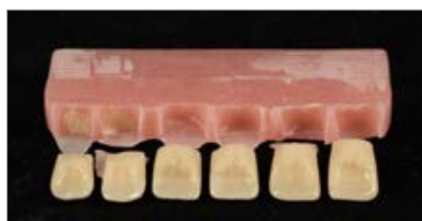
Abbildung 15 c: Padrão de fratura; Pré-tratamento da base do dente somente por jateamento
