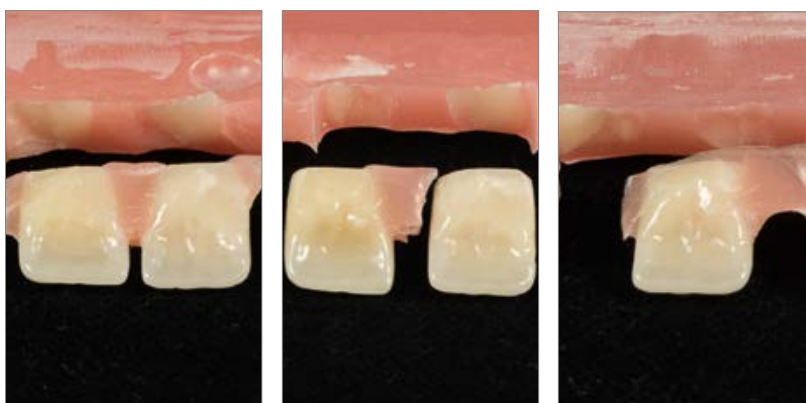
Figura 14 a – c: Padrão de fratura típico após o teste do compósito VITA PHYSIODENS com os materiais de base acima mencionados (Material de base da esquerda para a direita: FuturaGen, ProBase Cold, PalaXpress)
