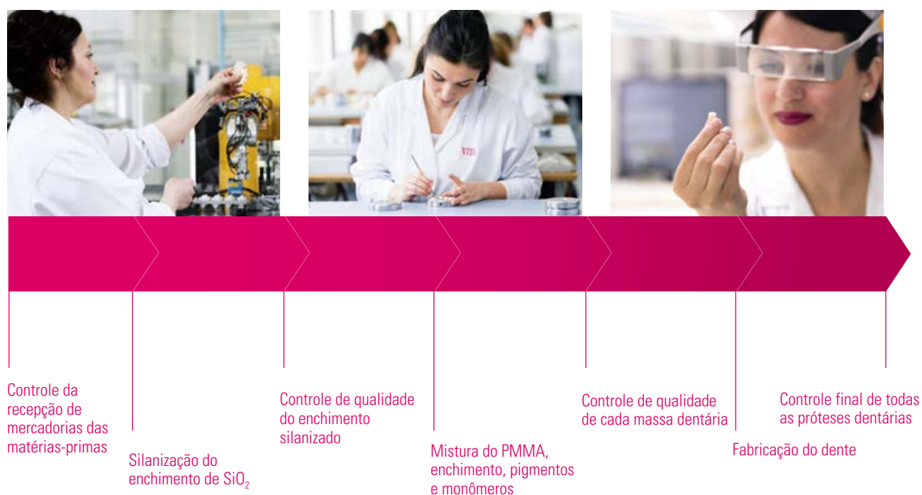
Figura 9: Processo para a fabricação de próteses dentárias VITA; Fonte: VITA P&D
