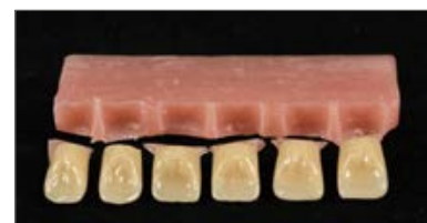
Figura 15 d: Padrão de fratura; A base de dente foi apenas umedecida com o agente adesivo
