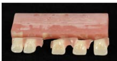
Рисунок 15а: Рисунок разрушения; базис зуба был подвержен пескоструйной обработке и покрыт адгезивным средством
