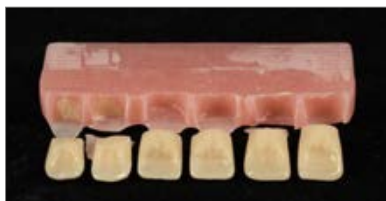
Рисунок 15 в: Рисунок разрушения; предварительная пескоструйная обработка
