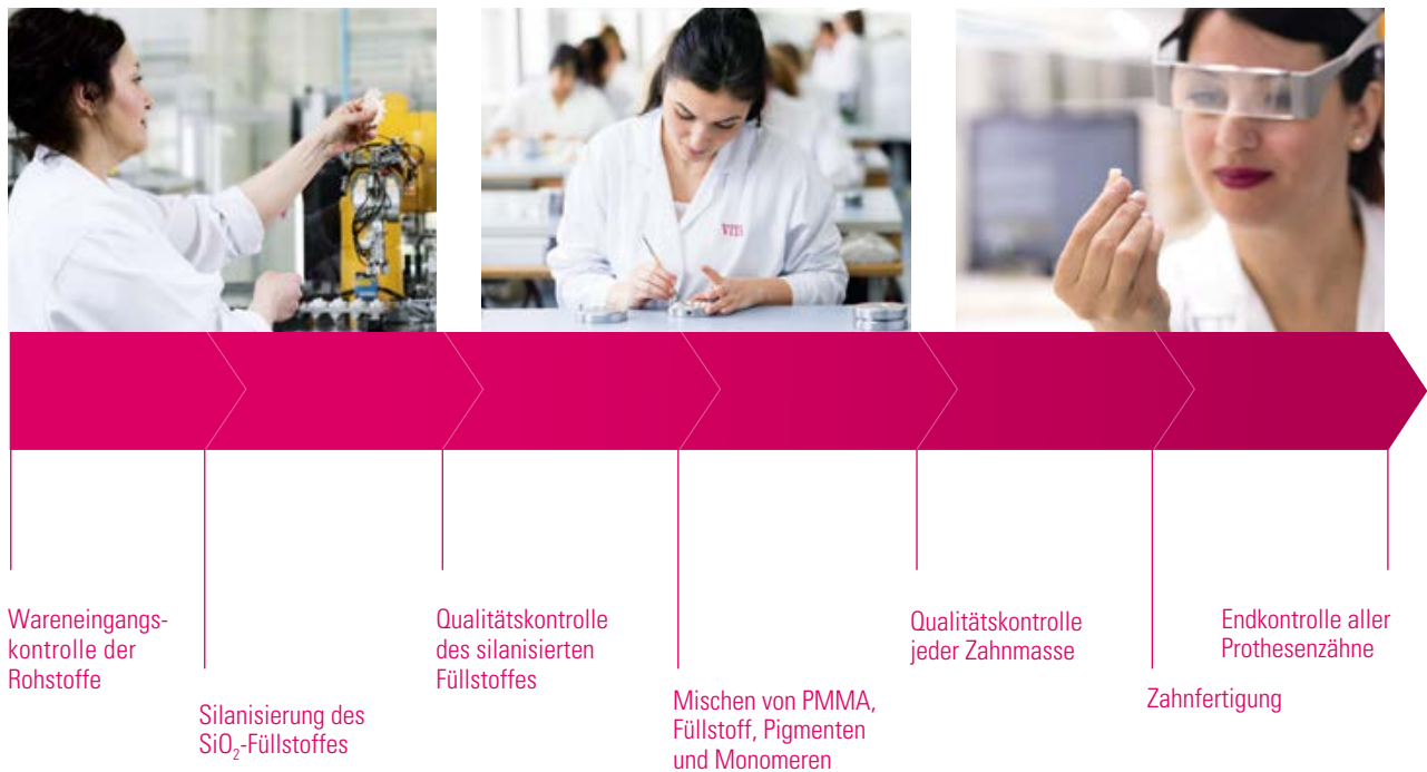
Abbildung 9: Prozess zur Herstellung von VITA Prothesenzähnen; Quelle VITA F&E
