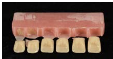
Abbildung 15 c: Bruchbild; Vorbehandlung der Zahnbasis lediglich durch Sandstrahlen
