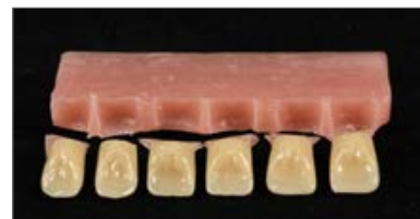
Abbildung 15 d: Bruchbild; Zahnbasis wurde lediglich mit Haftvermittler benetzt
