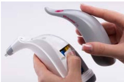
Abbildung 6 – Batteriewechsel: Oberschale aufstecken
