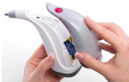
Figura 2: Sustrucción de la batería: retirar la cubierta superior
