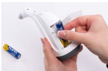
Figura 4: Sustrucción de la batería: extraer la pila izquierda
