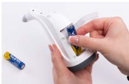
Illustration 4 – Changement de pile : retrait de la pile gauche
